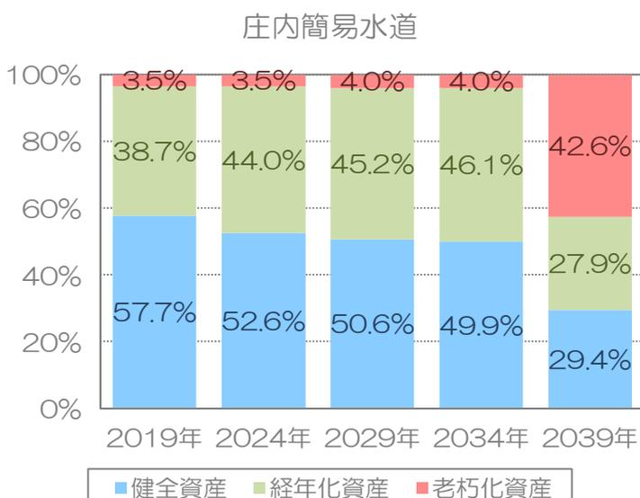
図 3.2.12 庄内簡易水道の老朽化の見通し
