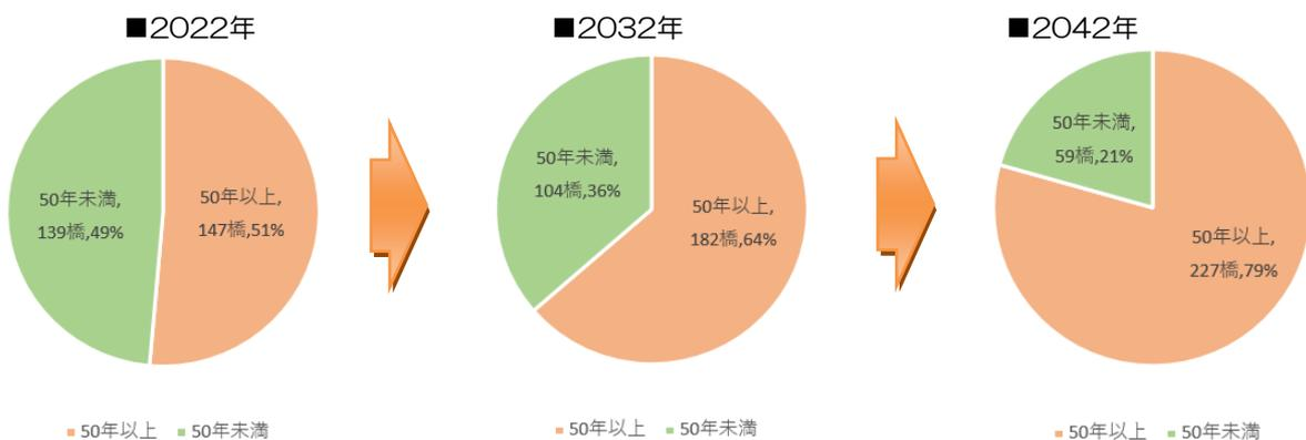
図14 架設後50年以上となる橋梁の割合
