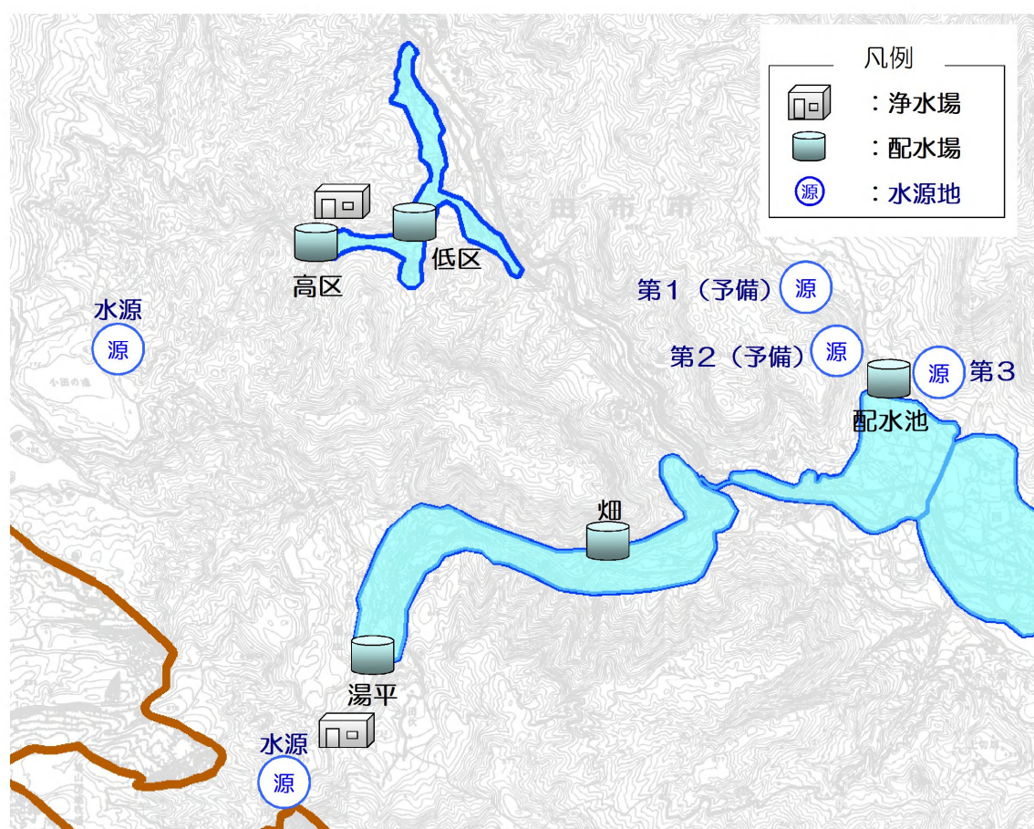
図 3.2.7 湯布院町水道事業（下津々良地区および湯平地区）の施設整備状況
