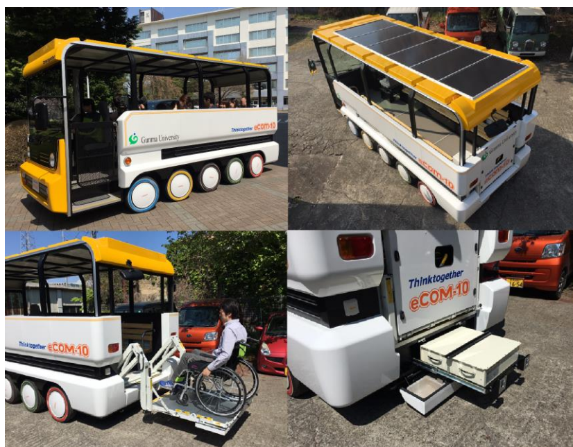
図 観光振興とコミュニケーション促進ツールとなりうる 低速電動コミュニティビークル「e-com10」(イーコム・テン)
